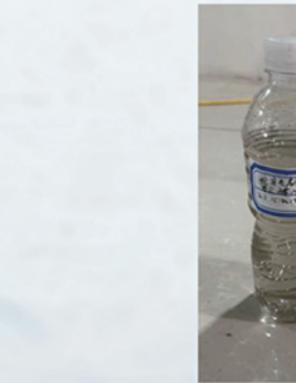
除污器安装前后17号楼5单元进 水水质情况对比
