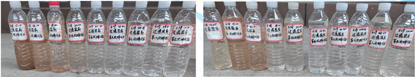
运行1天，洁水器（除污器）每次排污管道水质情况对比
