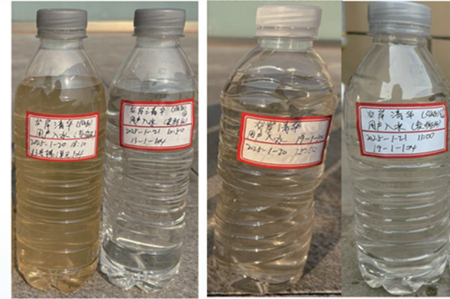
除污器安装前后13-1-104用 户入水水质情况对比
