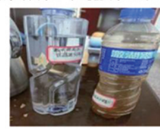
高区安装过滤器后水质和低区未安装过滤器水质对比
