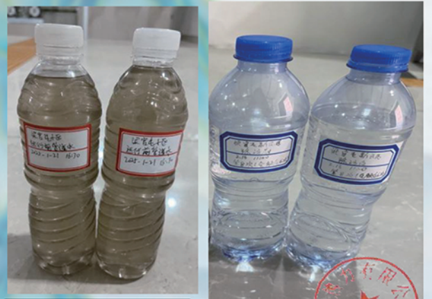
2025.1.21 除污器安装前 管道水质情况
