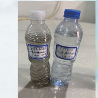
除污器安装前后16号楼5单元进 水水质情况对比
