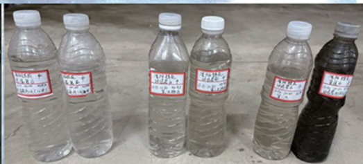
运行1天净水器(除污器)前后水质对比
