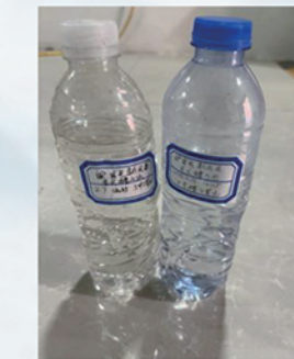
除污器安装前后5号楼2单元进 水水质情况对比
