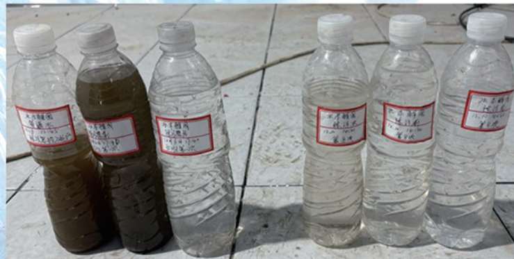
运行4天净水器(除污器)前后水质对比
