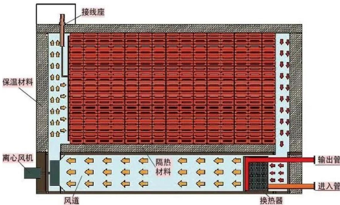
图 5-25：固体蓄热装置工作流程示意图【77】
