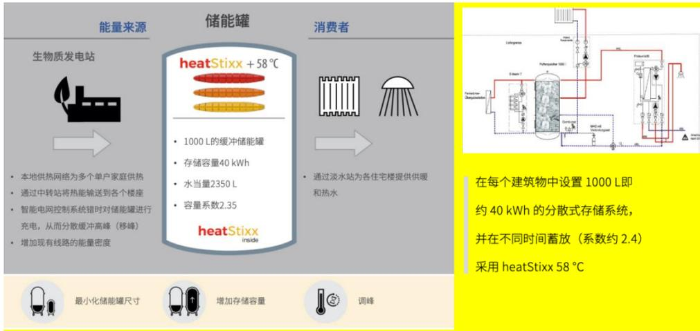
图 5-8: 德国施克伦生物质发电厂热电联产项目储能罐示意
