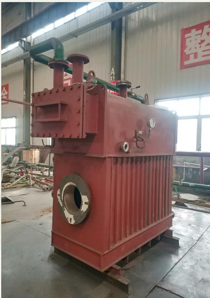
水管式真空（微压）炉本体
