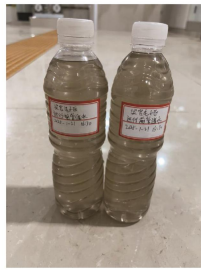
2025.1.21 除污器安装前管道水质 情况
