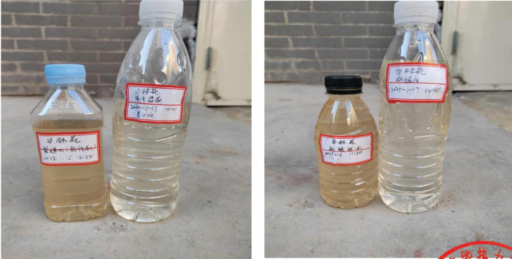
除污器安装前后管道水质情况对比
