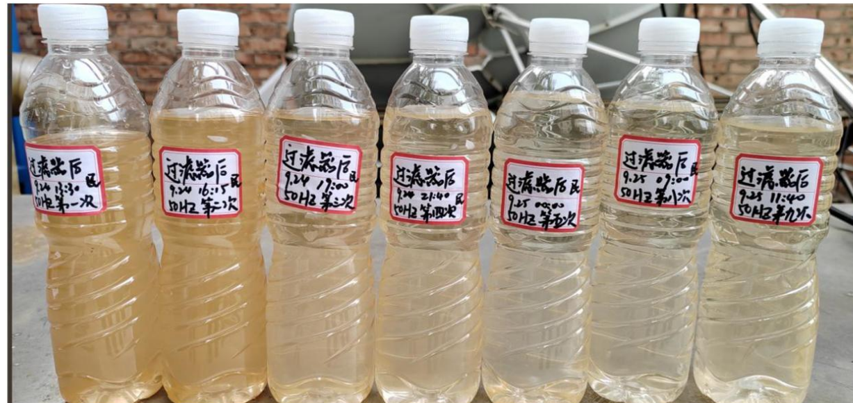
运行 2 天，除污器每次排污除污后水
