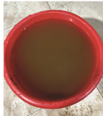
2025.1.20 22:00 除污器第一次排污杂质(变频后)
