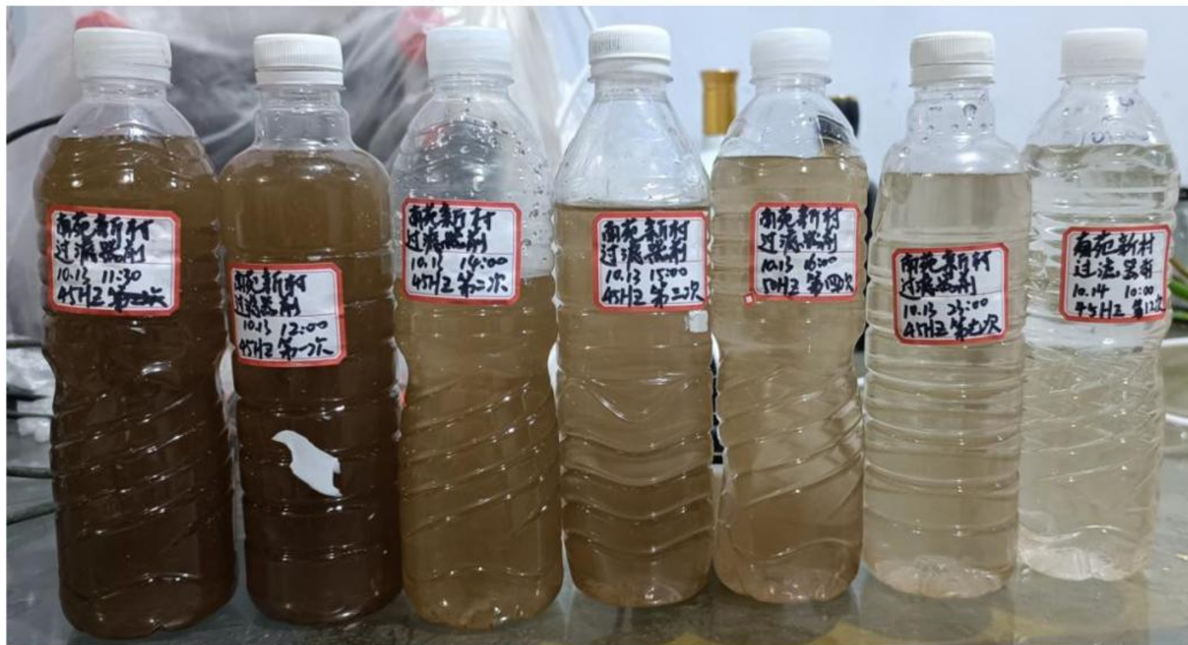
运行 2 天，除污器每次排污管道水质情况对比照
