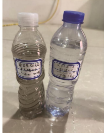
除污器安装前后 16 号楼 5 单元进 水水质情况对比
