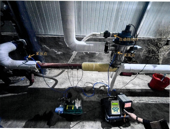
图 3 采压点除污器前连接管路与除污器出口处
