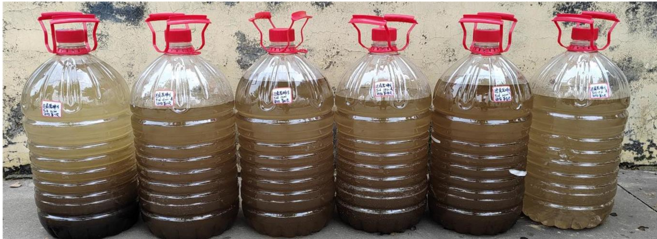
运行 1 天，除污器每次排污排污水质情况对比照
