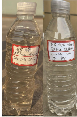
除污器安装前后 19-1-104 用户入水 水质情况对比
