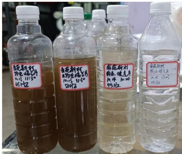
运行 2 天物业管道水对比
