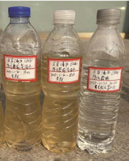
2025.1.20 日 18:00 调整变频管道水与 2025.1.21 日 10:20 除污器运行排污第四次 管道水对比
