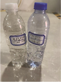
除污器安装前后 5 号楼 2 单元进水 水质情况对比
