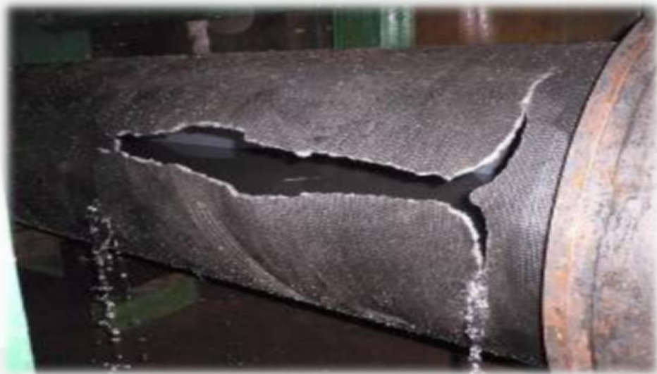
爆破试验DN800 9.7Mpa 接口完好
