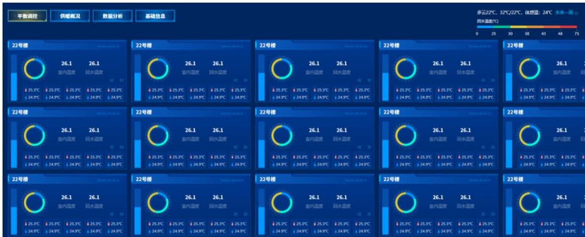
内置二次网平衡调节策略算法，根据支路设置的回水目标来判断并计算目标值，可清晰通过平面图显示各单元平衡状态，可实现自动调节，自动调节可以通过一键下发指令实现；也可以远程手动设定设备的采集周期、调控周期以及调控精度等。支持历史曲线查询功能，可以查询任意时间段内的室内温度、回水温度、阀门开度等曲线。
