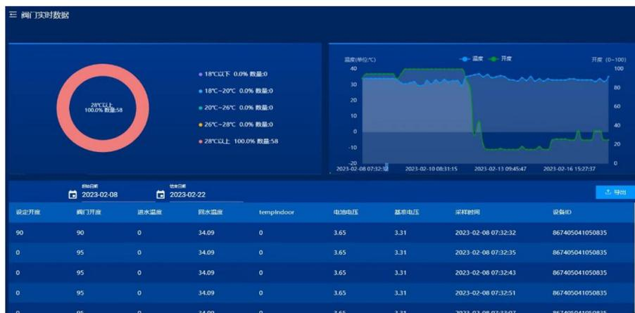
可以智能筛选温度读数，对于室温可以自定义成多个区间并用不同颜色标注显示，方便运维人员识别，同时设置了高温预警、低温预警、超高温预警、离线预警等意见筛选按键，方便快捷。另外，部分热力公司因为资金预算的问题，没有办法给所有住户装配室温采集器，可以挑选一些典型具有代表性的户型安装室内温度采集器（如：边户、顶层住户、中间住户、孤岛户等户型），我们可以根据代表户型测温数据，通过后台计算模拟估算出其他所有户型的室内温度，估算出的室温数据误差值不高于 $\pm 1^{\circ}\text{C}$ ，如下图：
