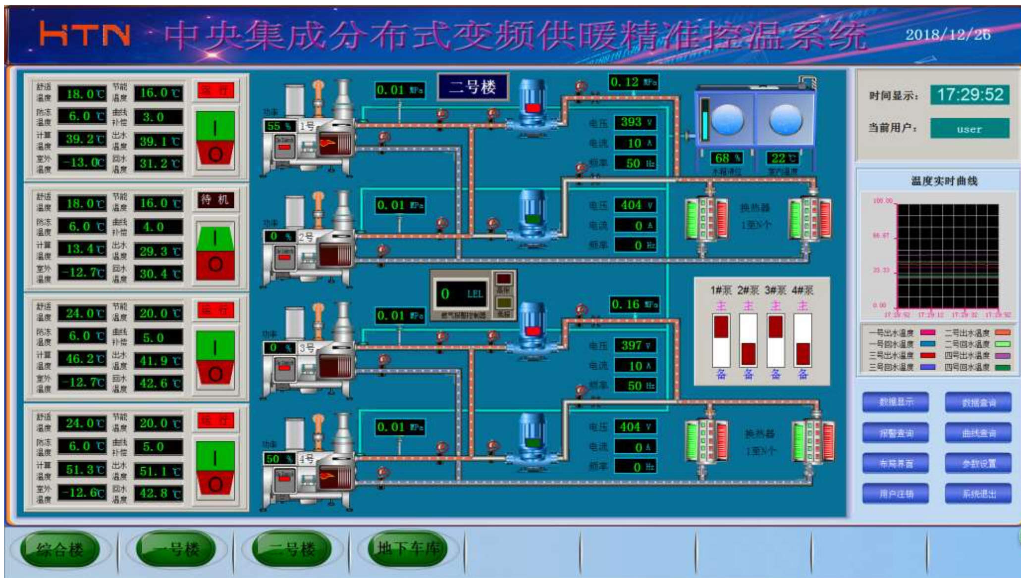
锅炉房远程监控界面
