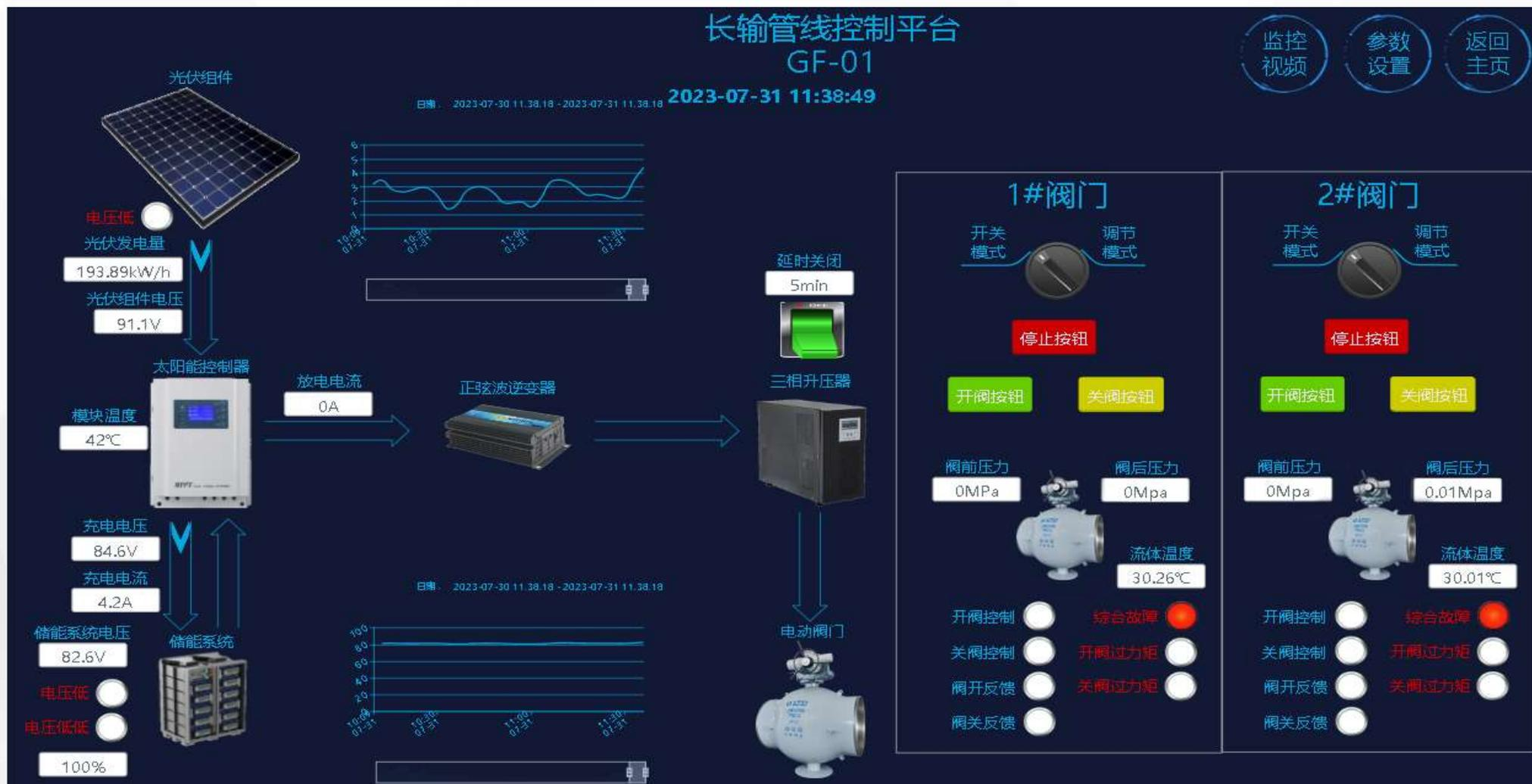
4: 通过管理平台, 可及时对阀门进行体检、维护和保养, 在供暖前可远程检查阀门的严密性和开关情况是否正常, 在停暖后, 把阀门进行全行程开关, 将粘附在球体上附着物清除掉, 进行维护和保养。
