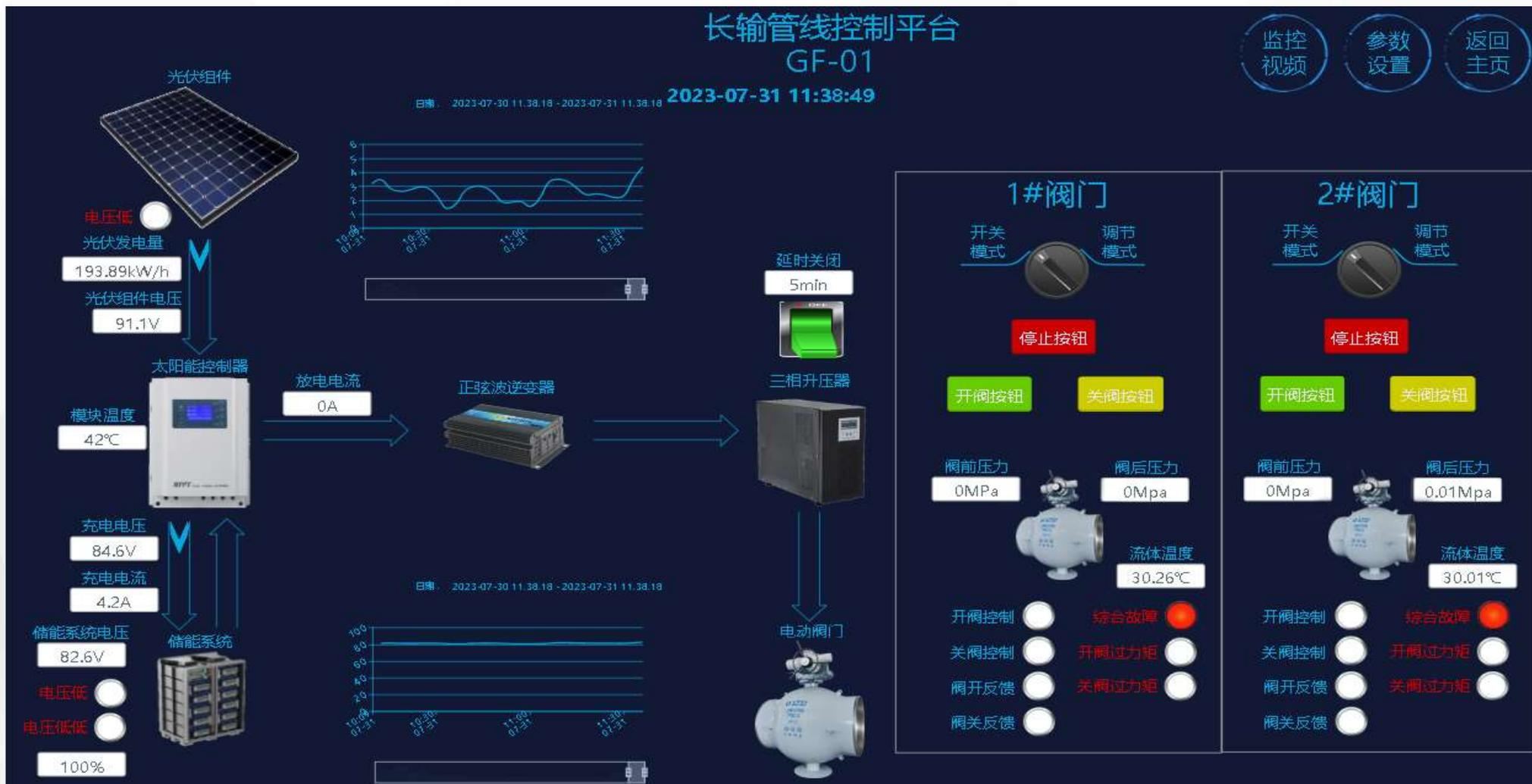
5: 可根据长输管网系统可能发生的各类故障, 提前制定应急预案, 包括故障内容、故障报警、处理措施、故障恢复等, 通过以上平台化的管理, 可达到《长输供热热水管网技术标准》当中对关断阀门远程控制的技术要求, 保障长输管线安全化、智慧化的运行。
