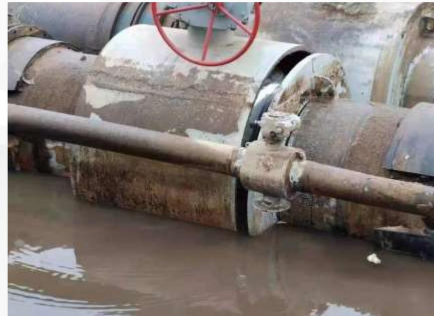
DN1000钢板制作焊接球阀拉断现场
