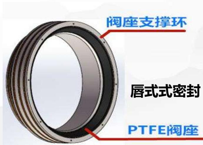
唇式密封的结构设计，通过支撑环外侧密封环负责和边阀体密封，阀座只负责和球体密封，彻底解决了原始填塞式造成的缺陷。
