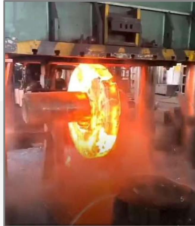
然后再把这个钢锭加温到**1200度**，在中间通过冲压设备，冲出一个园孔。在把这个冲出圆孔的钢锭，在加温到**1200度**，然后固定在辊压设备上，配置好相应的模具，在中间圆孔内插入芯轴进行辊压，需要多次加温，多次辊压，才能辊压成所需要尺寸，并且口径越大，辊压的次数就越多。
