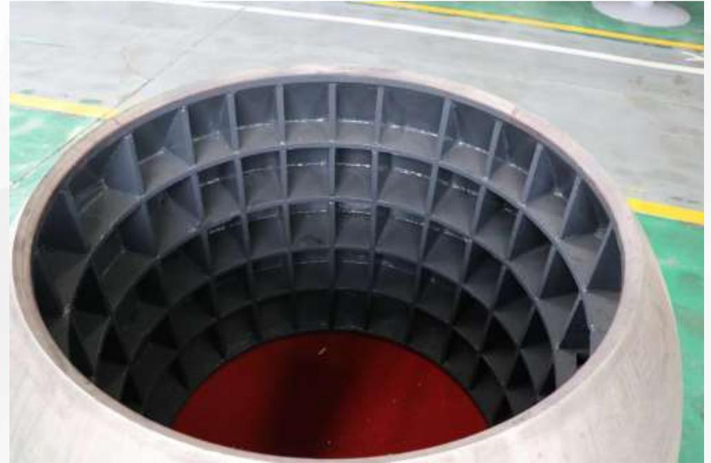
国家标准对球体的三个要求，（1）球体的强度在大于1.5倍的公称压力下，不产生永久的变形，（2）可保障球体与阀杆的连接面的强度，在大于2倍以上的阀门最大开关扭矩时不会产生损伤和脱离，（3）可保障阀门在全开时，球体的通道与阀体通道保持在同一轴线上。
