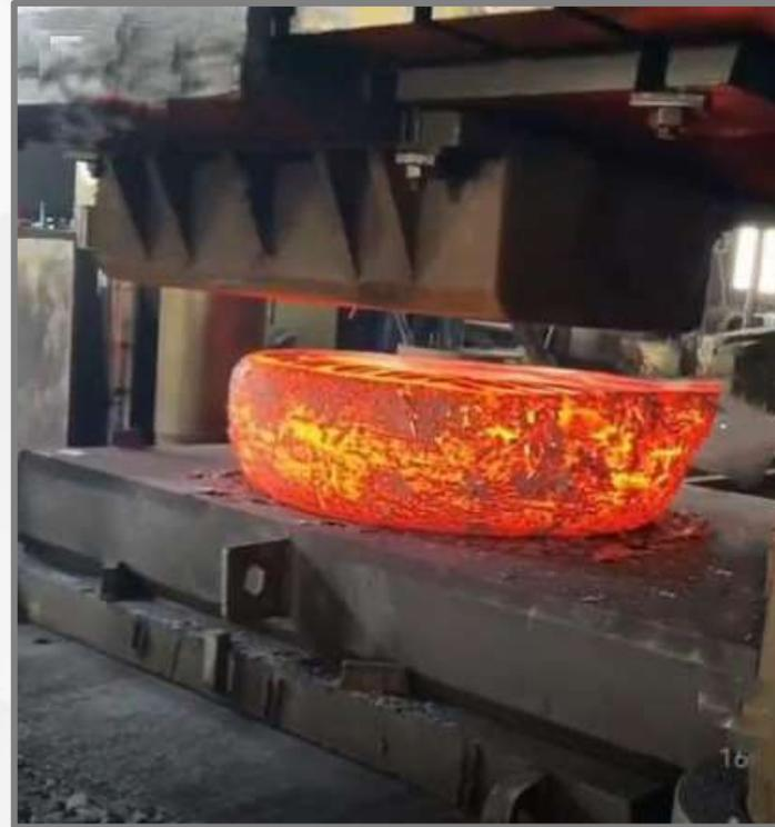
首先把选用好的圆钢加温到1200度，也就是圆钢再结晶温度，在通过锻压设备连续锻打，把圆钢内部因气泡、杂质造成的疏松消除掉，在按照不同口径的阀体所需要的尺寸和形状，锻打成一个圆形的钢锭。
