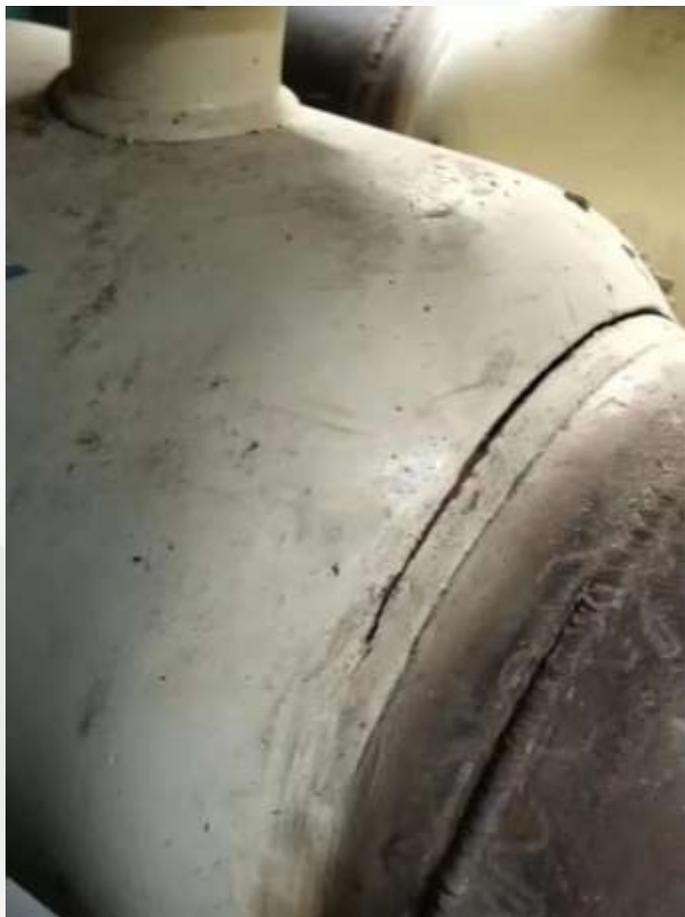
DN1000椭圆形结构被撕裂现场
