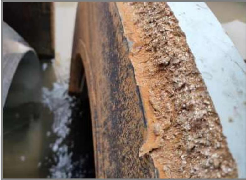
DN1000钢板制作焊接球阀拉断现场
